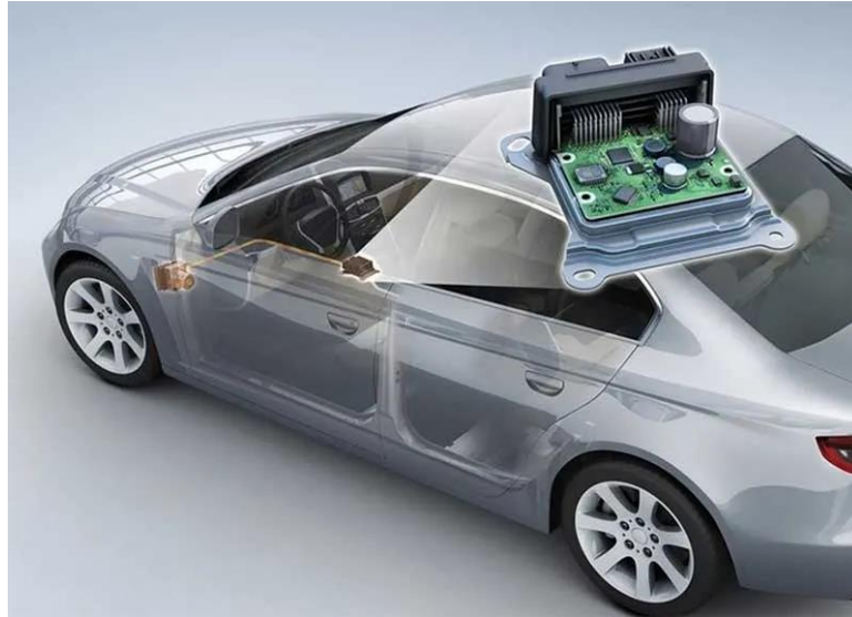
图4：分布式 E/E 架构一个功能一个 ECU，传感器和执行器直连独立 ECU
