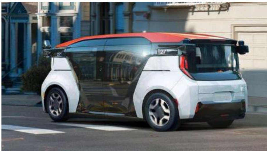
图：无方向盘和刹车系统的Cruise无人车
