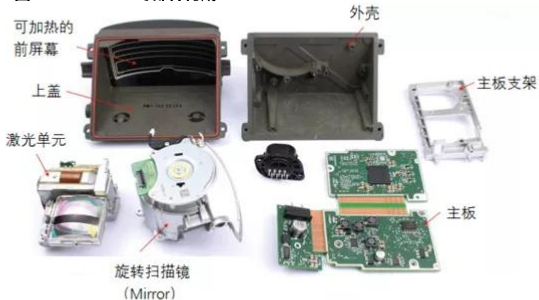
图：Valeo Scala零部件构成
