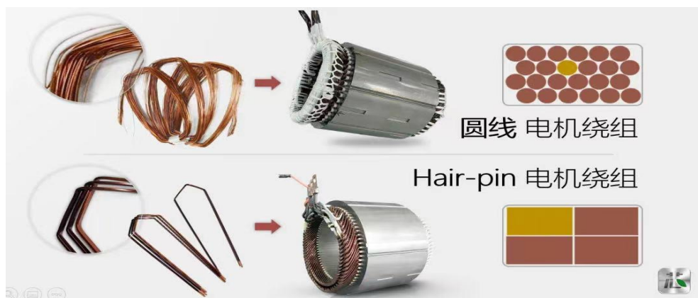
图29: 扁线有利于电机槽满率的提升
