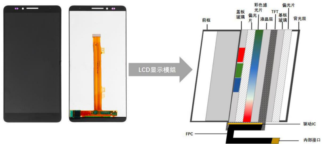
图 35: LCD 显示模组及驱动芯片示意图
