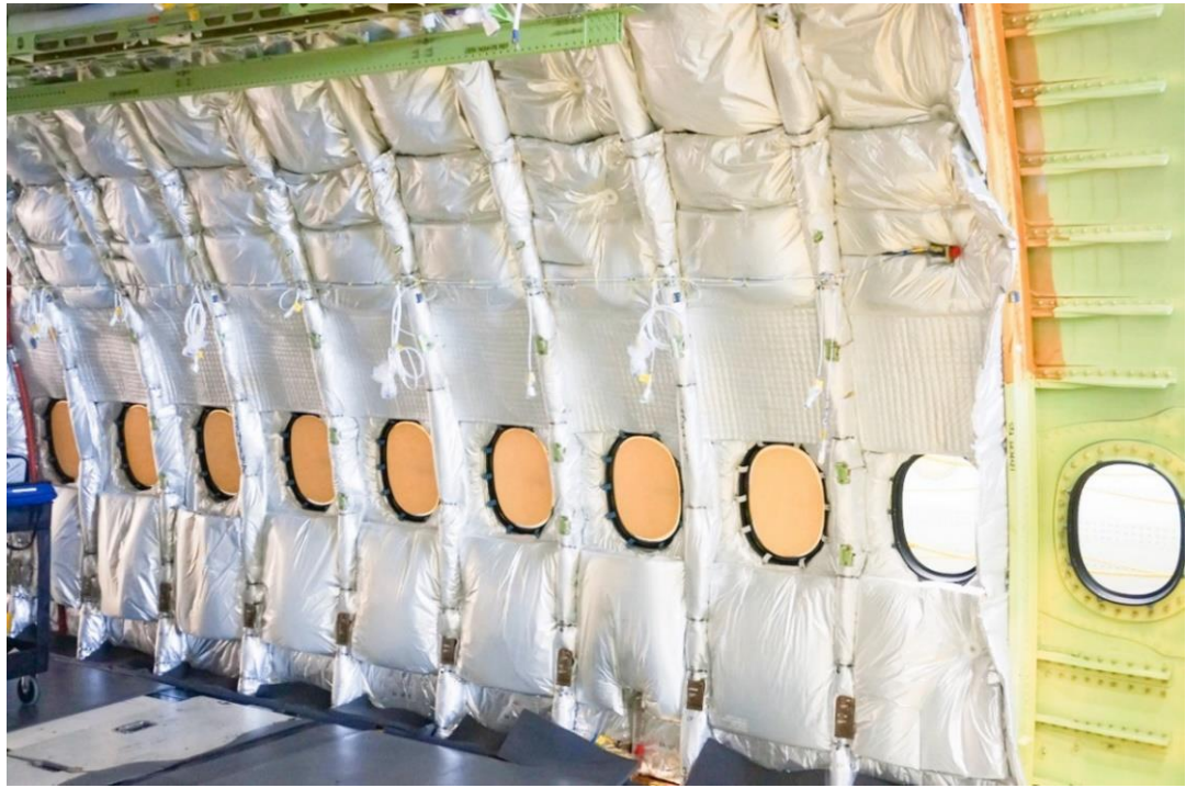
图表 47: 装配隔音隔热毯的机箱示意图
