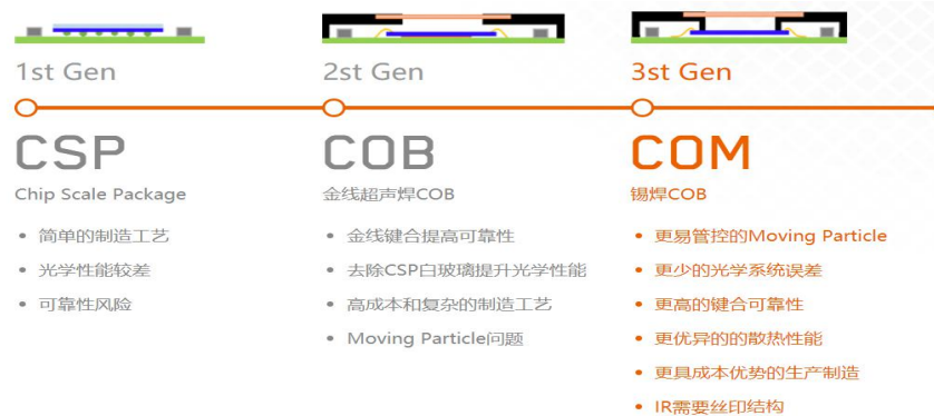
图 26：公司独有 COM 封装工艺
