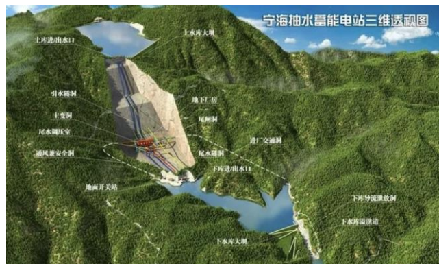
图 2：宁海抽水蓄能电站三维透视图
