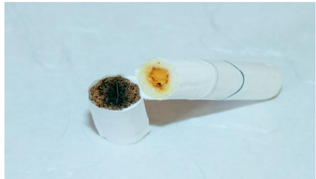
图 17：新型烟弹加热后内部情况
