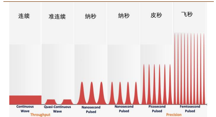
图 5：通过改变激光脉宽，可以实现不同精度的加工效果
