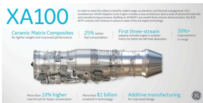
图表 31: XA100 发动机推力、燃油效率性能均有提升
