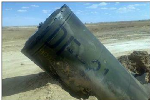
406钢制造的DF-21导弹一级发动机壳体
