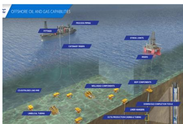
图表 62：海洋石油开采用高温合金（标注部分）
