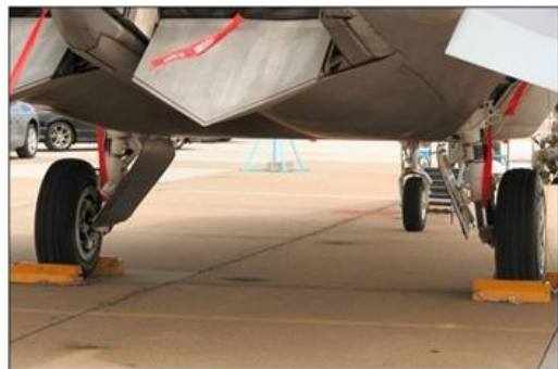
Aermet 100制造的F/A-22起落架
