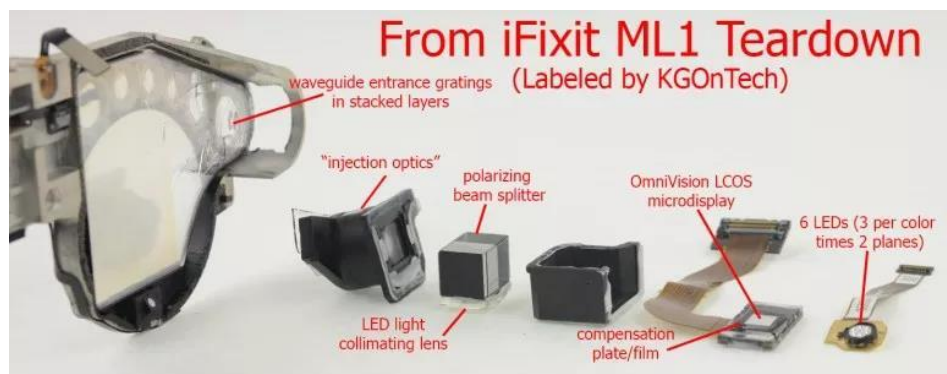
图表 33: Magic Leap One 光学元件拆解
