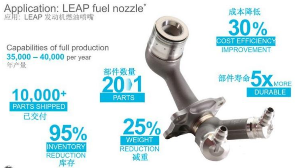
图 13: GE 一体化打印喷嘴取得成功
