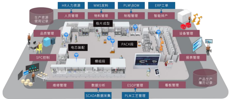
图 38：硬件设备覆盖极片成型、电芯装配、模组段、PACK段
