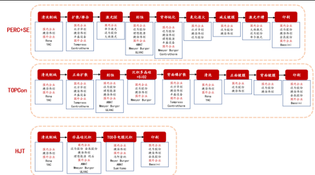
图 43：不同技术路线工艺流程对比，HJT 流程更为简化
