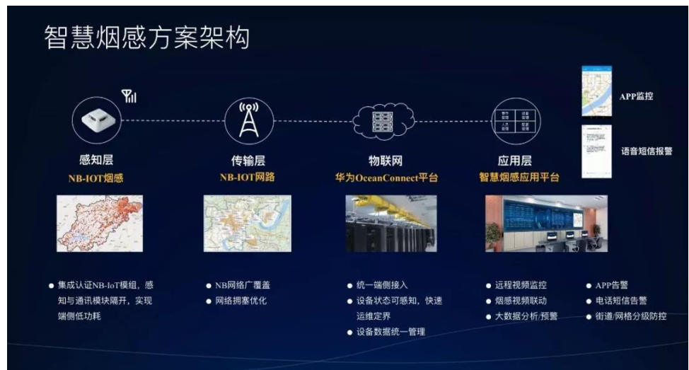
图 80：泛海三江智慧烟感方案架构
