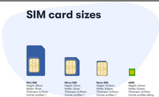
图 30：eSIM 卡与传统 SIM 卡尺寸对比
