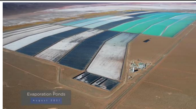
图表 19：盐田系统可实现锂的富集，先后提取钠、钾以及初步分离镁
