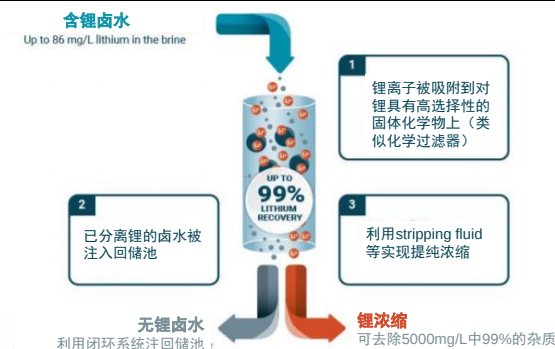
图表 30：直接提取技术 DLE 的原理
