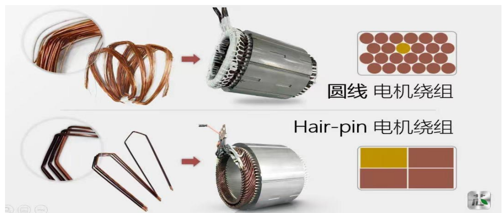
图15: 扁线有利于电机槽满率的提升
