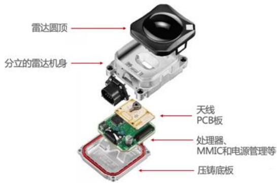
图 68 毫米波雷达拆解图
