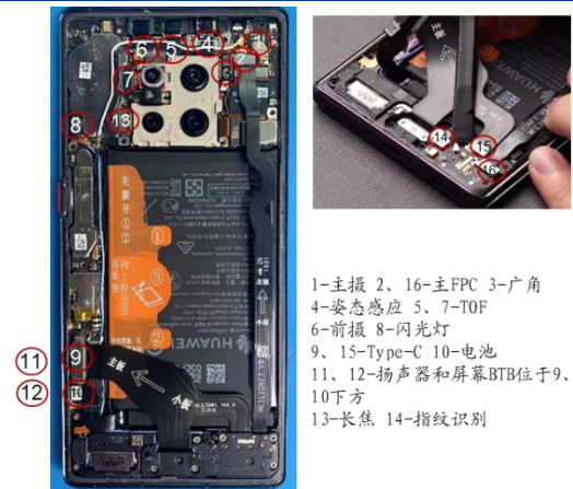
图表 65: 华为 mate 30 Pro (4G) 所用 16 对 BTB 连接器
