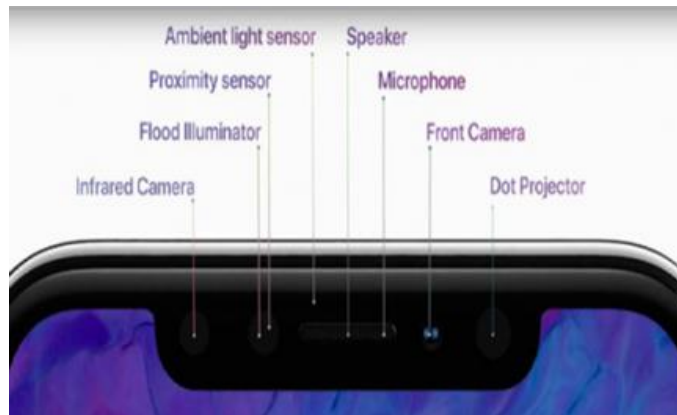
图表 75: 手机顶部模组结构
