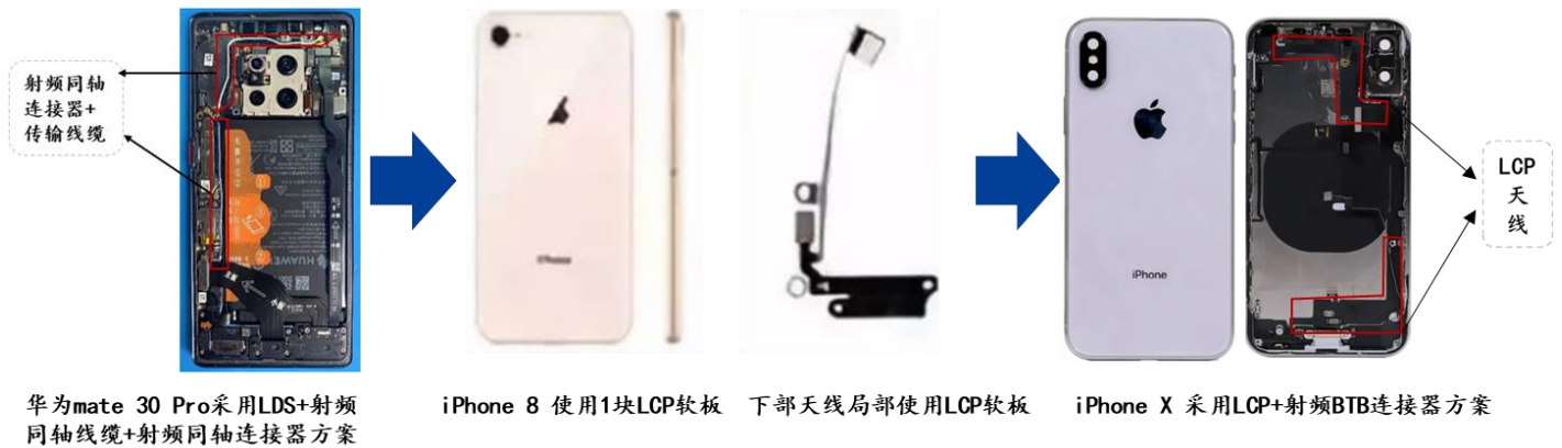
图表 72: 三种天线设计方案
