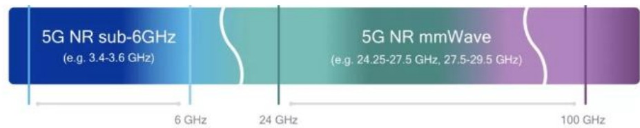
图表 70: 5G 传输频段: sub-6 & 毫米波
