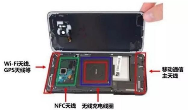
图表 53: 手机天线示意图
