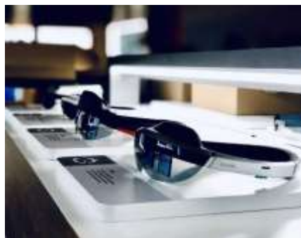
图 10：公司衍射光波导 AR 眼镜参考设计
