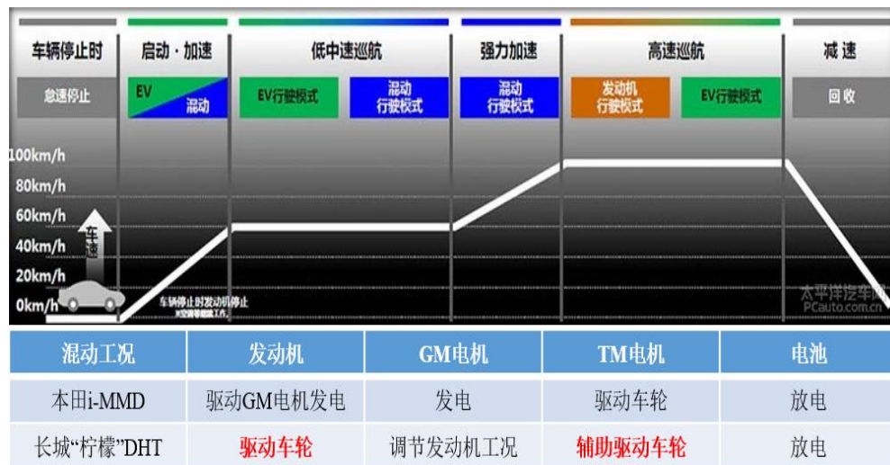
柠檬DHT系统与本田i-MMD系统混动驱动模式对比
