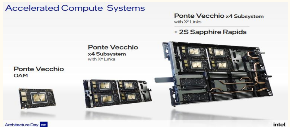
图表 5: 英特尔 AI GPU Ponte Vecchio 及 AI 服务器架构
