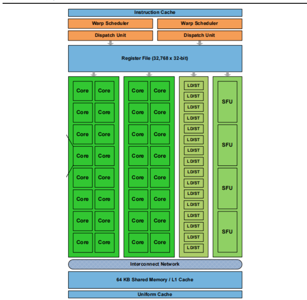
图 8: SM 内部结构
