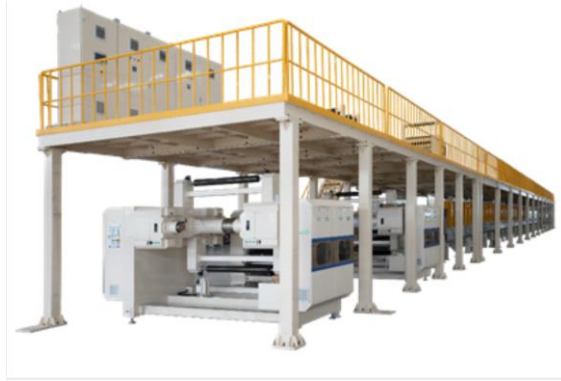
图 5：璞泰来双层宽幅高速挤压涂布机
