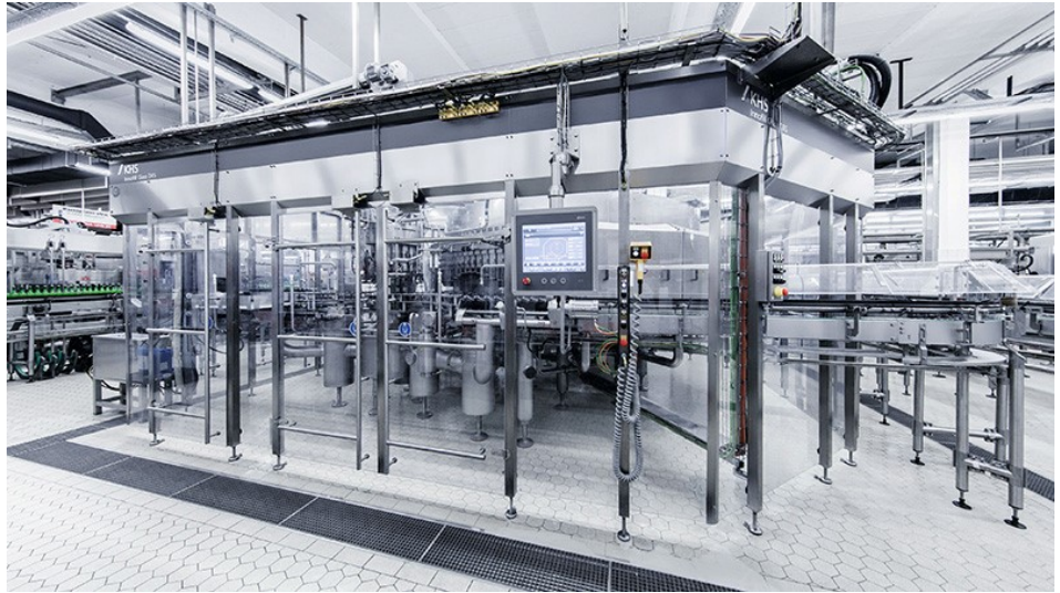
图 18: KHS 的 Innofill Glass DRS 高效的玻璃瓶装系统产能可达每小时 80,000 瓶
