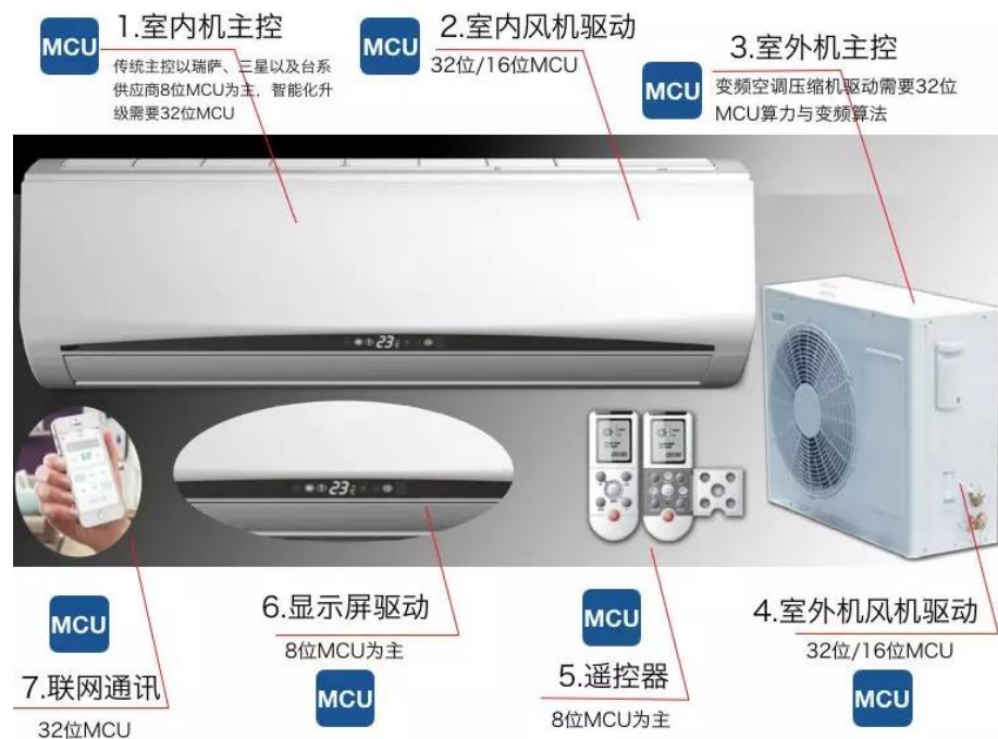
图 28: MCU 在分立式空调中的应用示意图
