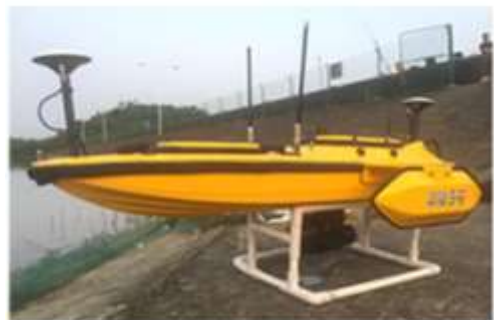
图 7: 华测导航无人船用于水文测绘
