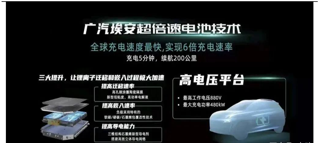
图9：广汽埃安的超倍速充电技术峰值功率达 480KW
