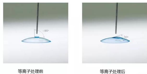
图 40：低温大气等离子处理技术提高表面湿润性，减少蛋白沉积
