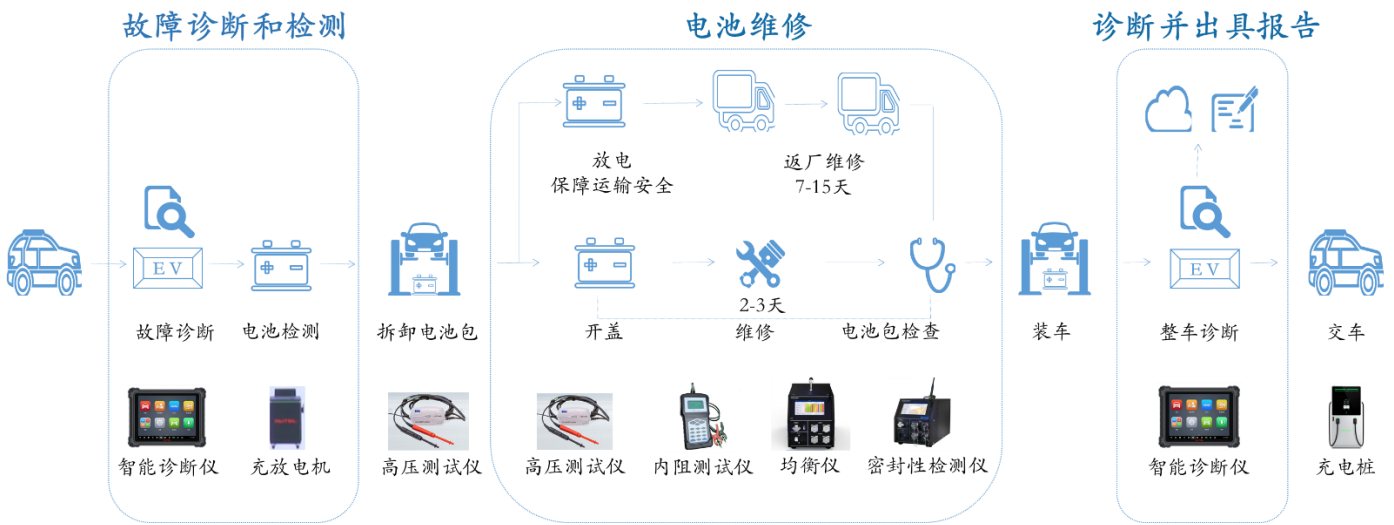
图表 4 公司新能源诊断检测系统
