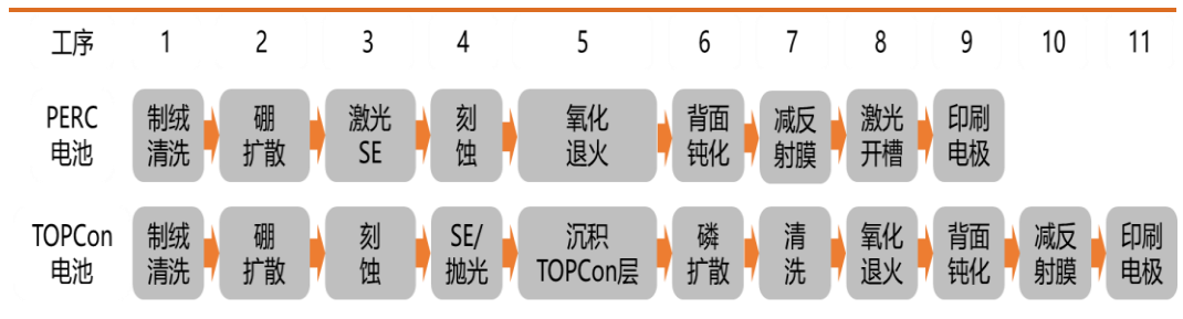
图 29 PERC 和 TOPCON 电池生产工艺对比
