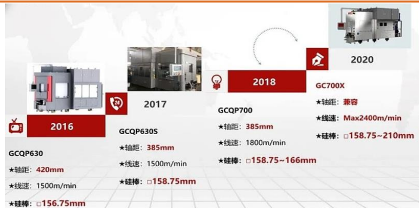
图 15 高测股份各型号切片机主要参数对比
