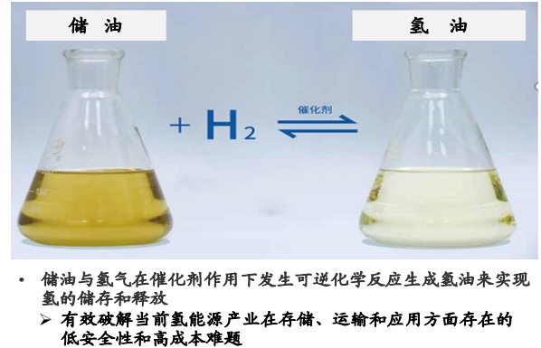
图 70: 常温常压有机液态储氢技术 (LOHC)
