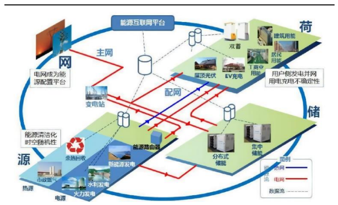
图 41: 源网荷储示意图
