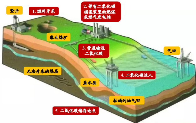
图 72：CCUS——碳捕集、利用与封存技术流程示意图
