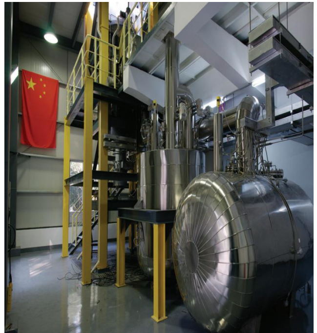
图 25：非能动熔盐自然循环实验装置
