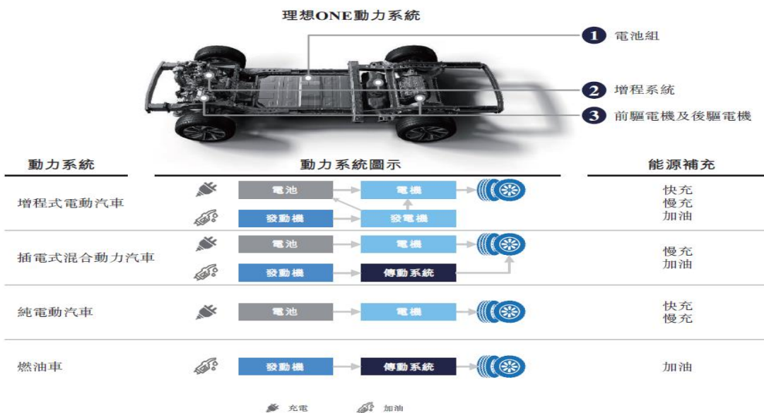
图表7 理想 ONE 增程式动力系统，增程式动力系统与其他动力系统的比较
