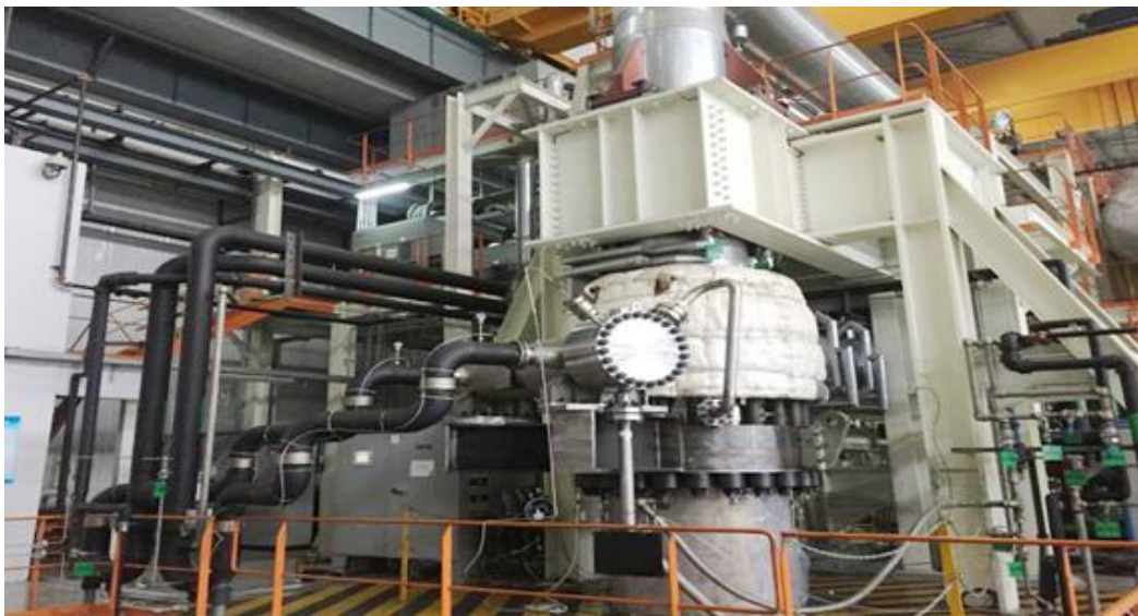
图表 11: AP1000 首台国产化屏蔽电机主泵在沈鼓 AP1000 主泵全流量试验台
