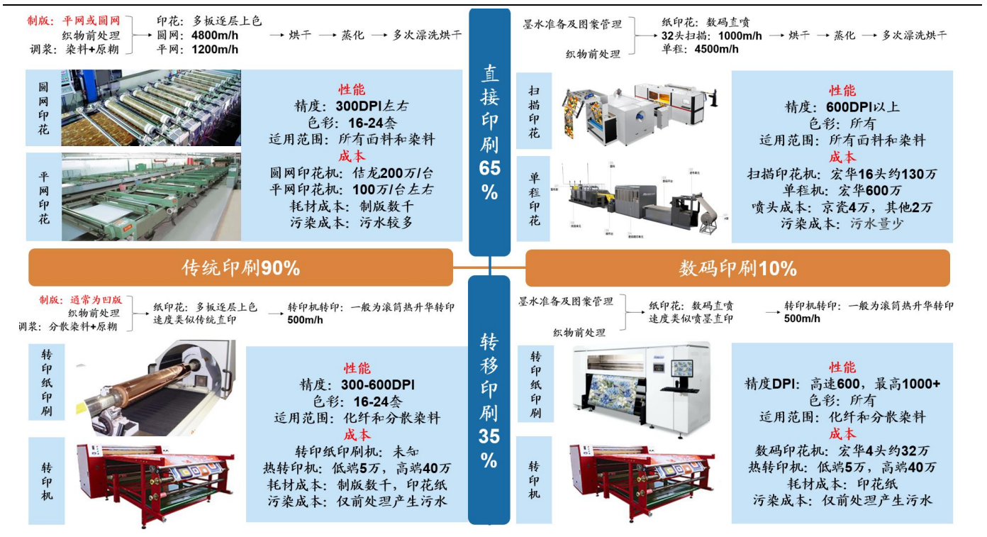
图 4：四大类印花工艺流程、设备、成本和性能比较
