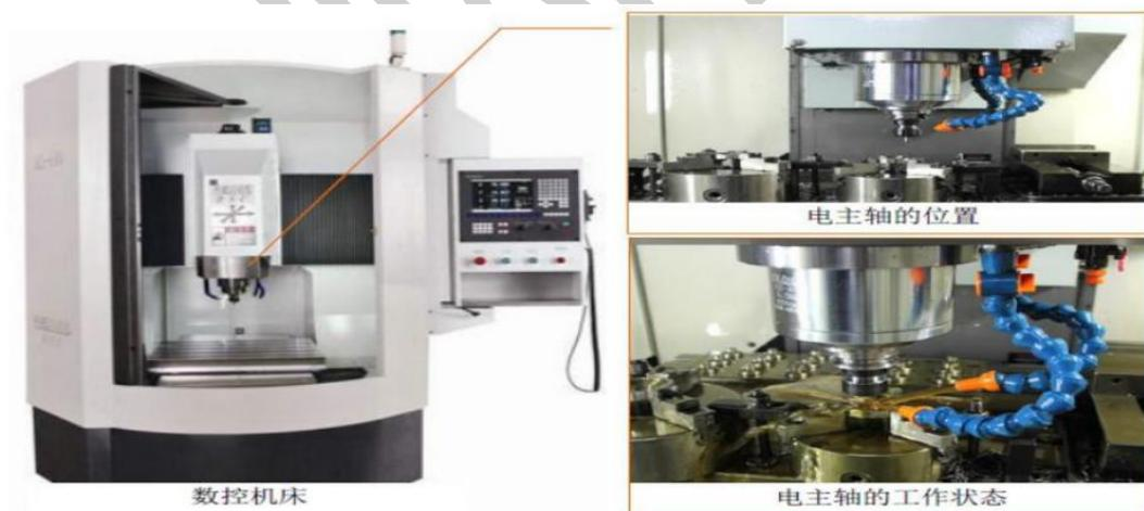
图：在数控机床工作中的电主轴
