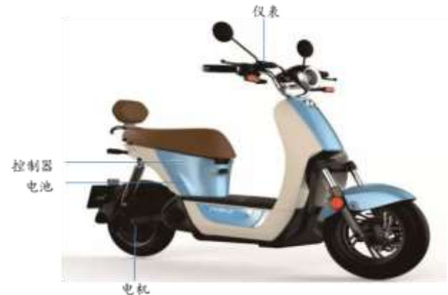
图 9: 两轮电动车核心零部件示意图
