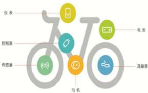
图 8: 助力电动自行车核心零部件示意图
