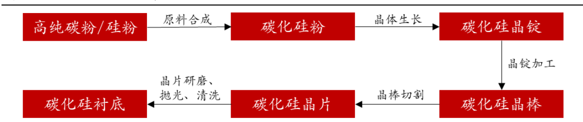
图表 3. 公司碳化硅衬底生产流程
