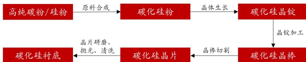
图表 3. 公司碳化硅衬底生产流程
