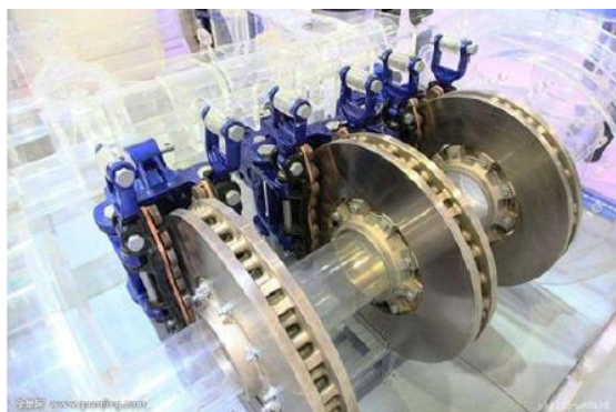
图表 30：制动闸片刹车示意图
