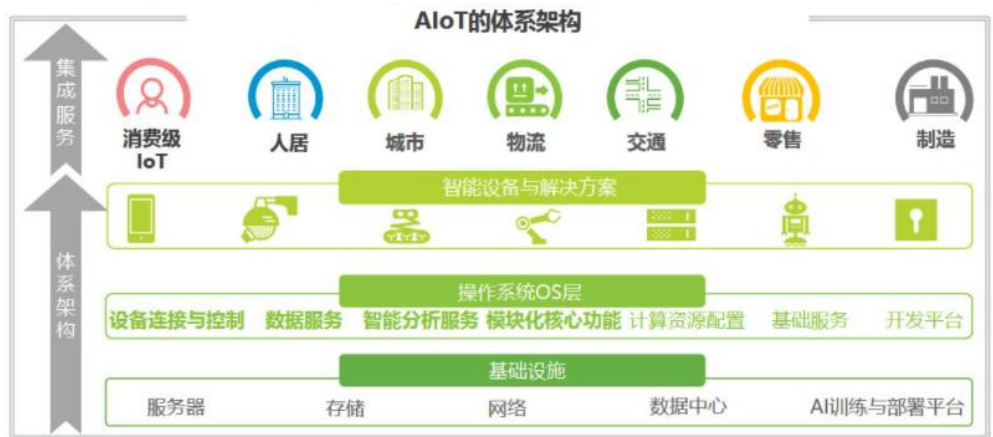
图 64：AIoT 的体系架构
