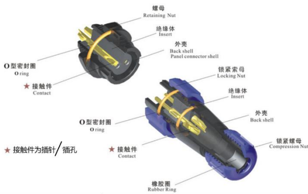
图 1 同轴连接器结构
