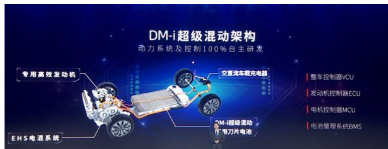
图 28 DM-i 超级混动架构图
