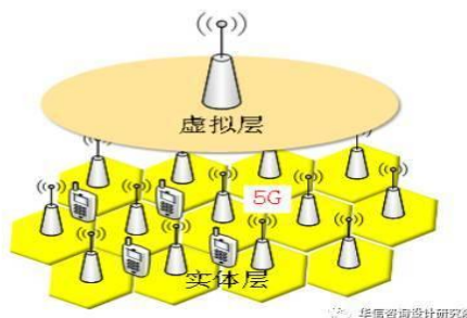
图 56: 超密集组网虚拟技术原理示意图
