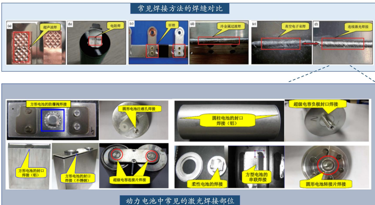
图 41: 激光广泛适用于各类动力电池生产环节中的精密焊接
