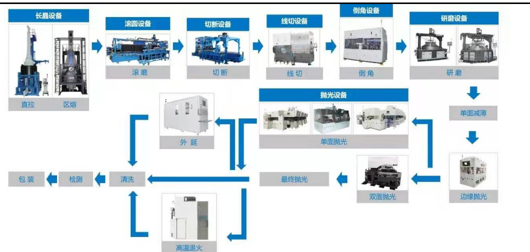
图 4: 公司形成了生长、切片、抛光、外延四大核心装备为主的完整产业链布局
