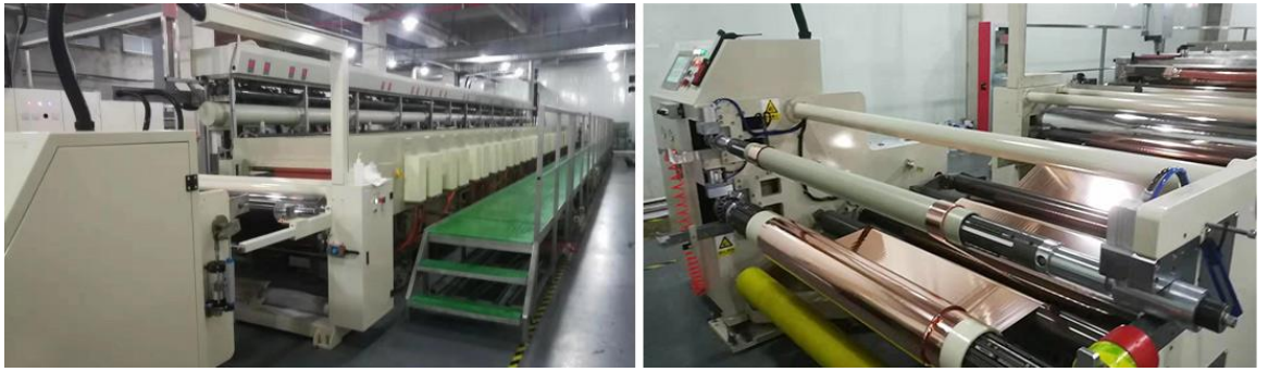
图表 27. 东威科技用于生产 PET 复合铜箔相关设备 RTR-HP 系列
