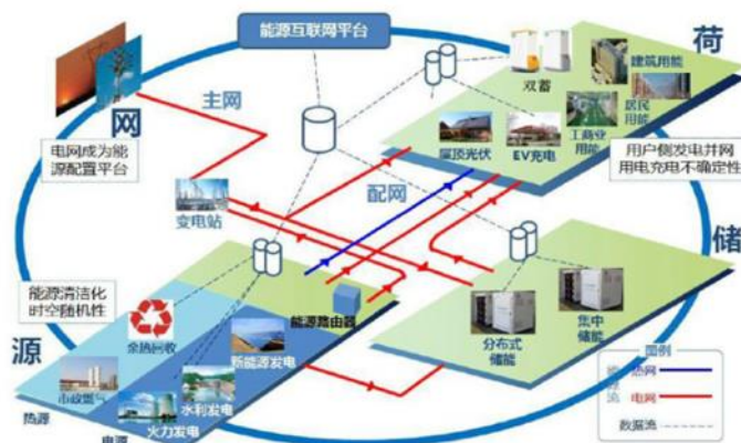
图 8: 能源互联网平台中配电网枢纽示例
